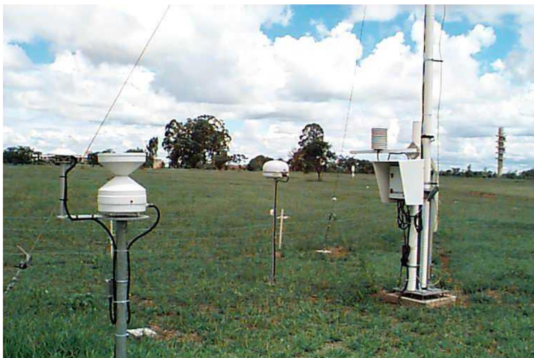
Detalhe de uma Estação Meteorológica Automática (EMA), mostrando a esquerda o pluviômetro, ao centro a antena de comunicação via satélite e à direita o "datalogger" com sensor de temperatura presos ao mastro.
